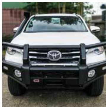
Pare-buffle renforcé, prise treuil, clignotants, feux antibrouillard
