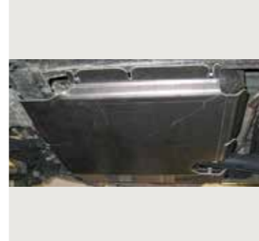
Plaque de protection - Boîte de vitesse & Boîte de transfert Gear/Transfer skid plate PRADO Ref. 20TF0058
