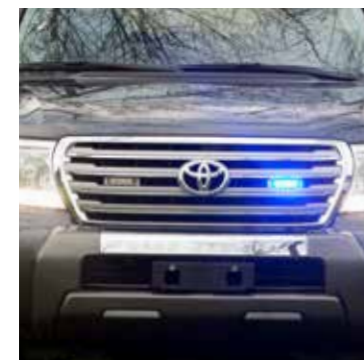
Lampes à flash dans la calandre, alternantes, bleu/bleu (x2) Alternating flashlights inside front grill, blue/blue (x2) Ref. 10TF0099
