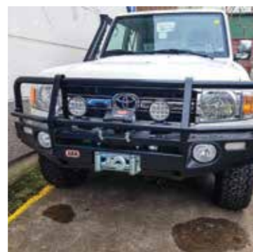
Pare-buffle renforcé, prise treuil, clignotants, feux antibrouillard
