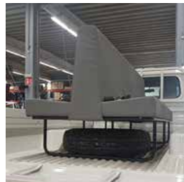
Banquette dos à dos, total 6 ou 8 places, vinyle, ceintures de sécurité
