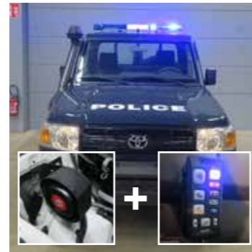
Rampe lumineuse Bleu/Bleu ou Bleu/Rouge, LED, sirène et haut-parleur sous le capot Lightbar Blue/Blue or Blue/Red, LED, siren under bonnet, PA system Ref. 10TF0098
