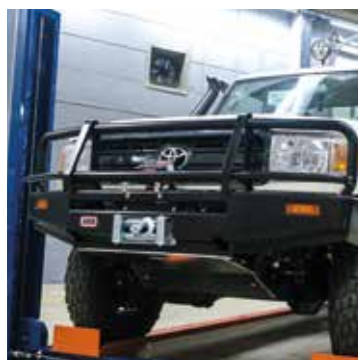
Pare-buffle renforcé, prise treuil, clignotants
