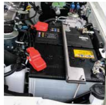
Batterie additionnelle 12V, 90 A/h
