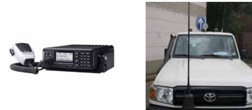
Radio HF ICOM IC-F8101 radio, avec antenne AH-760
