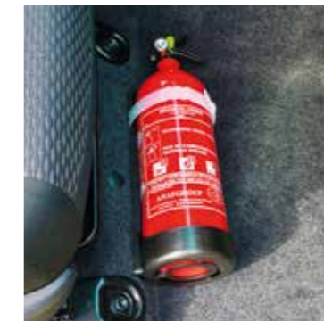
Extincteur 2 kg, installé
