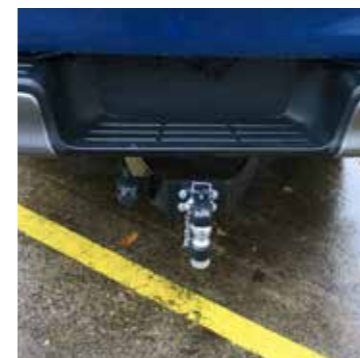
Barre de traction avec boule d'attelage - 50mm, prise élec. 7 broches
