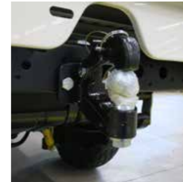
Crochet / boule d'attelage - 50mm
